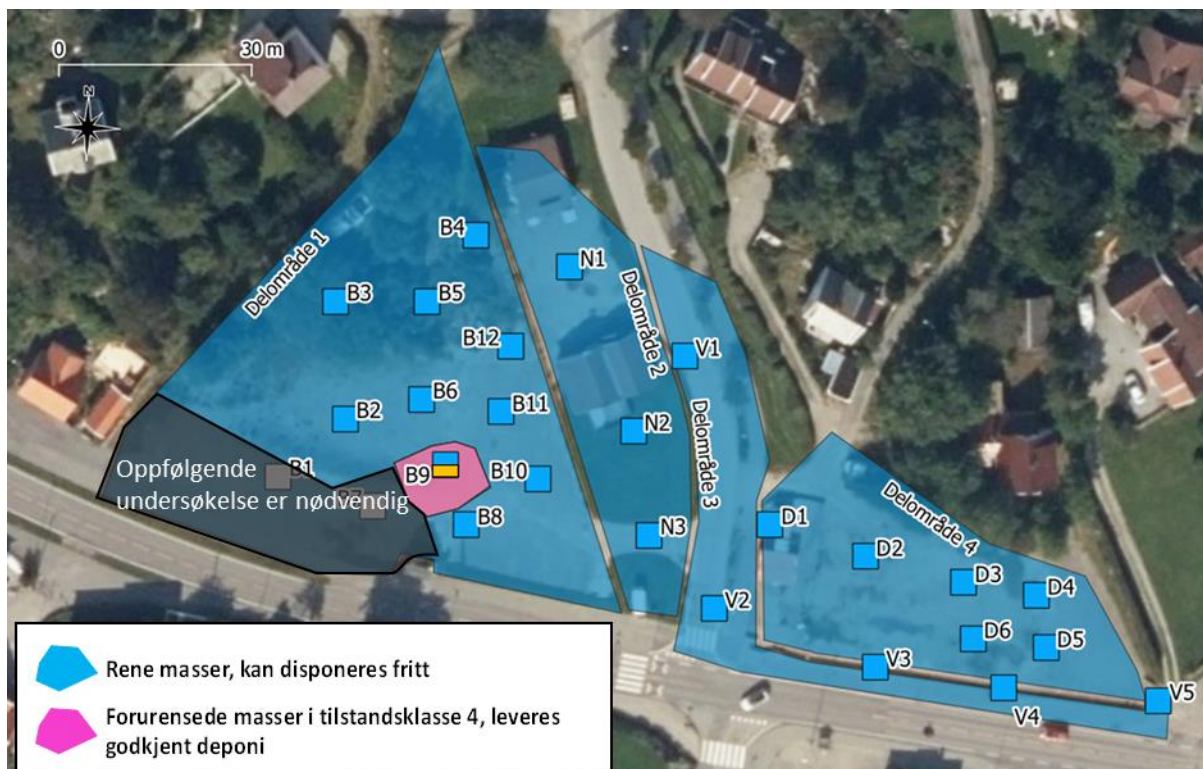
Figur 4. Anbefalt massehåndtering av toppjord (<100 cm), basert på tilstandsklassifisert analyseresultater. Påvist tilstandsklasse i toppjord (0-100 cm) er angitt med firkant for hvert prøvepunkt (Blå = tilstandsklasse 1, oransje = tilstandsklasse 4 og grå = ikke prøvetatt). For prøvepunkt B9 er massene forurensset i tilstandsklasse 4 i jordsjiktet 50-100 cm.
