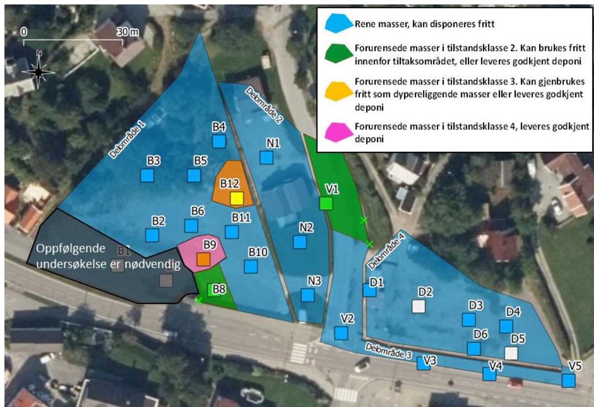
Figur 5. Anbefalt massehåndtering av dypereliggende jord (>100 cm), basert på tilstandsklassifiserte analyseresultater for hvert prøvepunkt (angitt med firkant; blå = tilstandsklasse 1, grønn = tilstandsklasse 2, gul = tilstandsklasse 3, oransje = tilstandsklasse 4 og grå = ikke prøvetatt/analysert).
